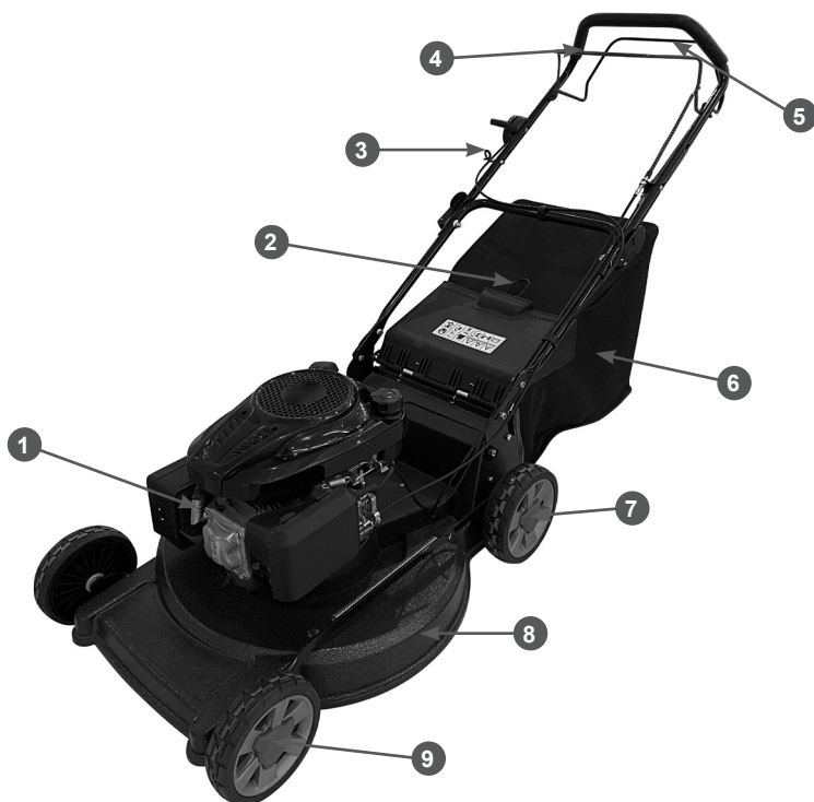
Рис. 2 Основные узлы и органы управления (вид слева)
